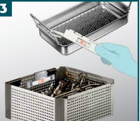
Ajuste de forma segura el dispositivo de prueba dentro de las **cestas medias o inferiores del instrumento** o sobre el **perímetro** del bastidor de enjuague y desinfección y asegúrese de que no entre en contacto con el brazo pulverizador. En caso de limpiadores ultrasónicos, **ajústelos de forma segura a la cesta del instrumento**.
